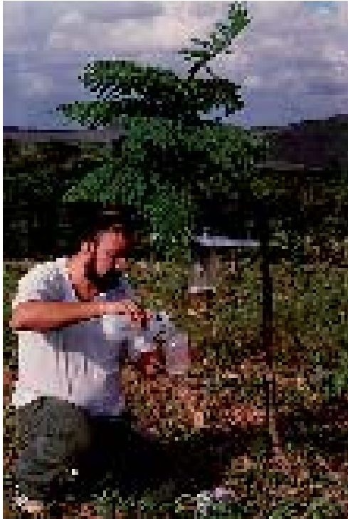
Figura 1. Dispositivo de captura noturna CDC Light Trap, contendo um depósito com álcool a 70 % na sua parte inferior (a).
